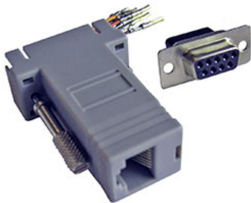
Правый порт розетки предназначен для подключения к СОМ порту персонального компьютера или конвертера RS232-Ethernet с помощью входящего в комплектность поставки переходника розетка RJ-45/розетка DB-9F и прямого патч-корда.
